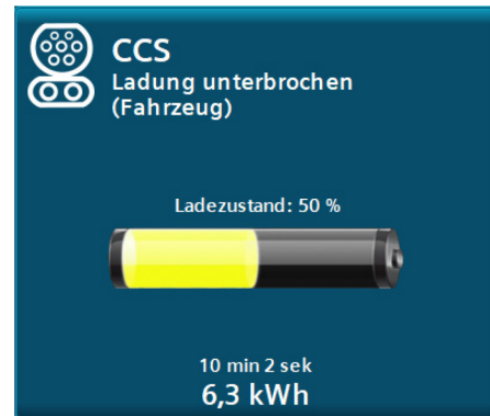
Abb 16: DC-Ladevorgang "Ladevorgang durch Fahrzeug unterbrochen"
