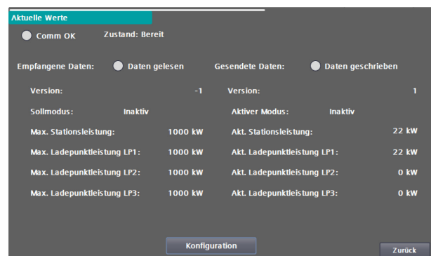
Abb 36: Datenstruktur des externen Leistungsmanagements für die Aktualwerte
