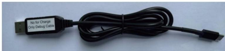
3. Choisissez 115 200 bauds pour le débit en bauds. Sélectionnez COM(X) USB-SERIAL CH340 pour le numéro de communication. Français. Si le port USB-SERIAL CH340 n'est pas présent dans la liste, l'ordinateur portable doit installer un pilote. Veuillez installer le pilote série sur le disque U : Debug Cable Serial DLL setup \CH341SER\SETUP. Après avoir double-cliqué sur SETUP pour installer le pilote série, il affichera USB-SERIAL CH340.
