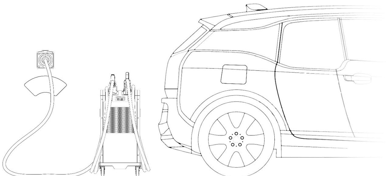
Stecken Sie das DC Kabel und das AC Kabel in den Schnelllader ein. Verbinden Sie nun das AC Kabel mit dem Netz.
