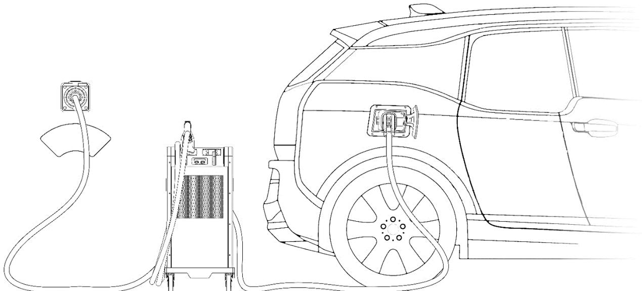
Stecken Sie nun den DC Stecker in Ihr Fahrzeug. Je nach Ladeprotokoll startet die Schnellladung automatisch oder Sie müssen am dem Schnelllader den START Knopf drücken. Während des Ladens können Sie sich über die Menüstruktur verschiedene Ladeinformationen anzeigen lassen.
