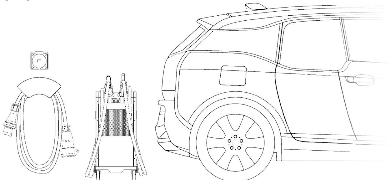
Für das Schnellladen benötigen Sie einen möglichst leistungsfähigen Netzanschluss, optimalerweise ein CEE63A/400V Industriedose. Parken Sie ihr Fahrzeug so dass der Schnelllader mit den mitgelieferten Kabeln den Netzanschluss erreicht und die Kabel am Boden liegen und nicht gespannt sind.
