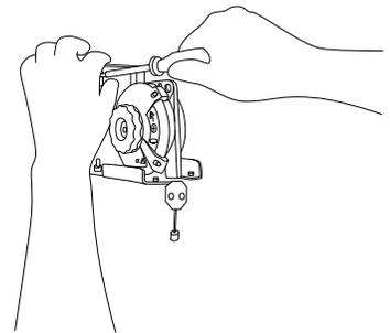
Die mitgelieferten Dübel (Z1) einsetzen und die Halterung mit den Schrauben (Z2) befestigen.
