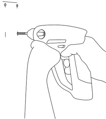
Die vier Bohrlöcher mit einem Bohrer 6mm vorbereiten.
