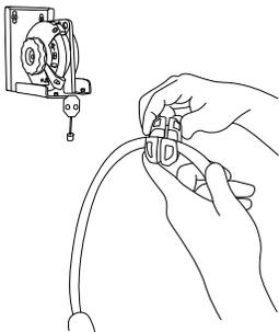
Montiere die Kabelschelle (Z4) mit den Schrauben (A1) und Mutter (A4)
